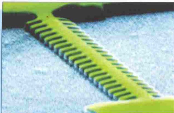
Figura 1. Microfotografía de un resonador cuántico, tomada del artículo de Gaidarzhy. Es un oscilador con forma de antena hecho de silicio de 10 micrómetros de longitud y 400 nanómetros (nm) de ancho. Tiene dos arreglos de paletas de 500 nm de longitud y 200 nm de ancho. El grosor de la estructura es de 245 nm.
